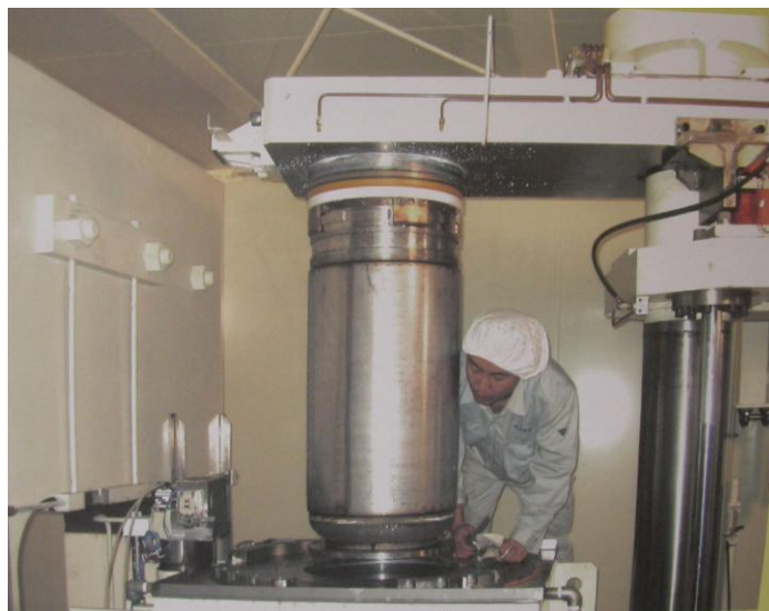
图4 日本越後制菓公司立式超高压设备装填物料的机械手
